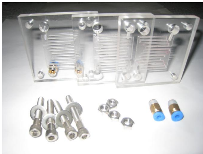
Figura 4- Platos colectores de corriente
