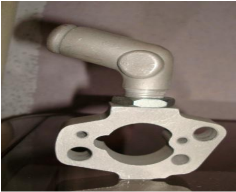
Figura 4. Válvula reguladora de flujo de biogás Figura 5. Mezclador adaptado al sistema
