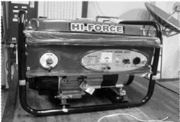
Figura 3. Grupo electrógeno utilizado como prototipo
