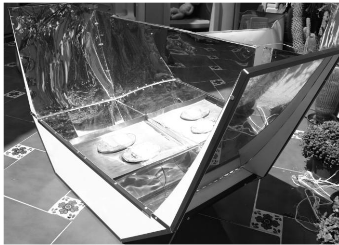
Figura 13. Prototipo del horno-comal solar Tolokatsin 3 en operación. Nótese el espejo plano articulado transversal a los espejos curvos. Este puede plegarse, al igual que los espejos curvos que sobresalen del absorbedor de sección trapezoidal, en el que se han colocado unos “tlacoyos”, alimento prehispánico del antiguo Anáhuak.
