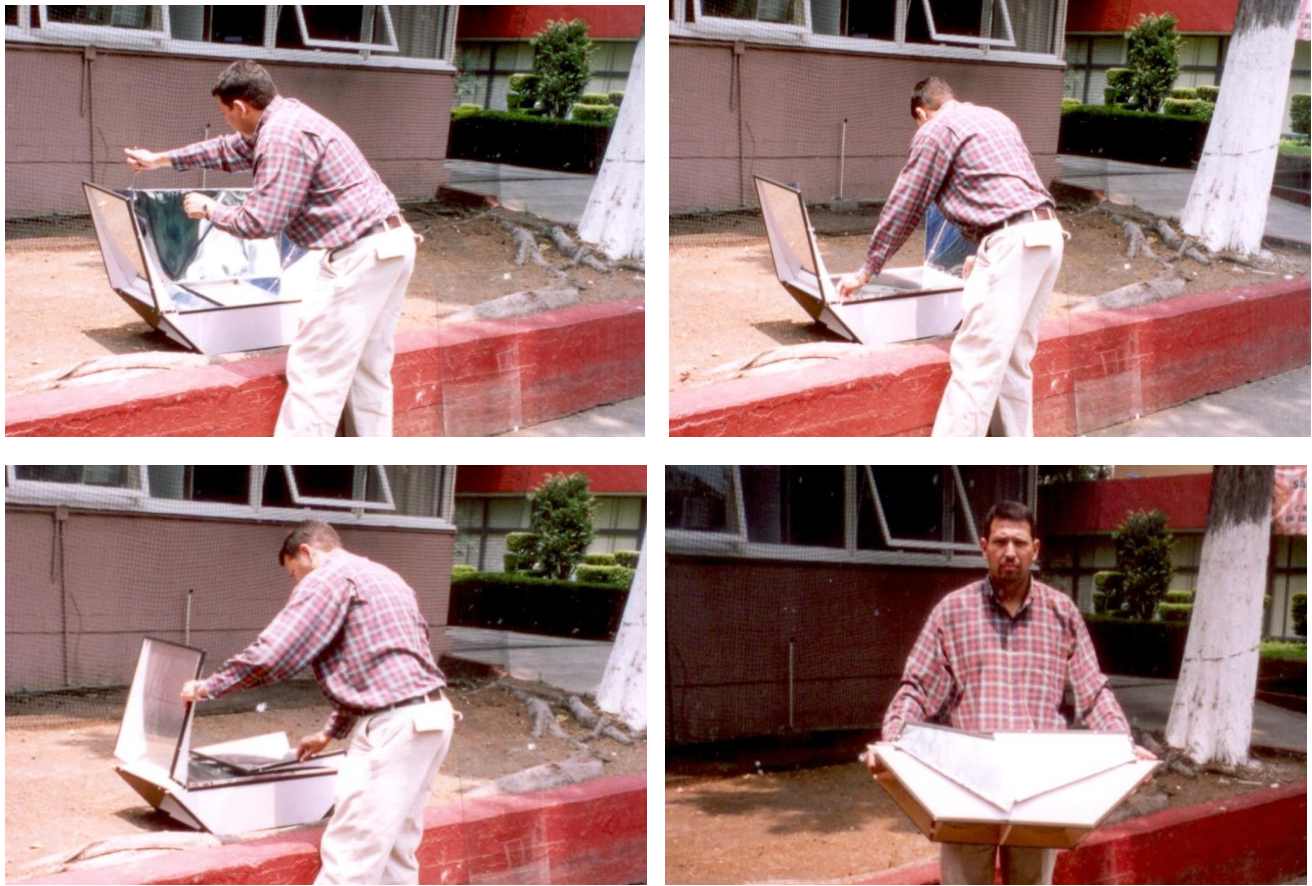
Figura 14. Proceso de plegado y transporte manual del horno-comal Tolokatsin 3. Los espejos curvos laterales y el espejo plano posterior se pliegan para disminuir el espacio ocupado y facilitar su transporte.
