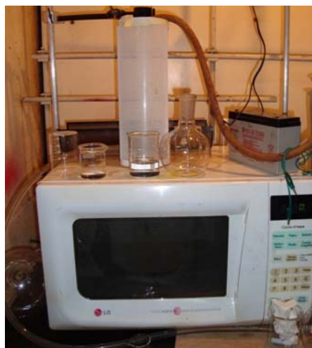
Figura 1. Foto de microondas modificado para la síntesis de materiales nanométricos.
