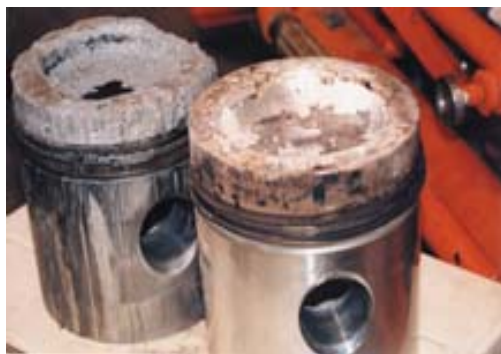
Figura 1. Corrosión de la cabeza del pistón por contenido de ácido sulfúrico [8]
