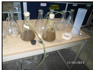
Figura 1. Biodigestor discontinuo
