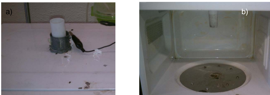
Figura 1.- Adaptaciones en el microondas para el reflujo (a) y para agitación magnética (b).
