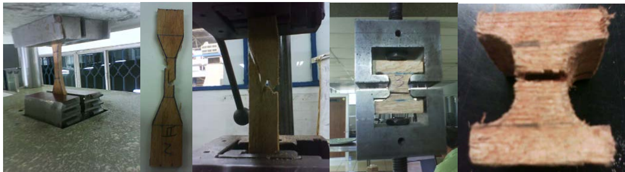
Figura 8. Imágenes de las probetas para tensión paralela y perpendicular a la fibra.
