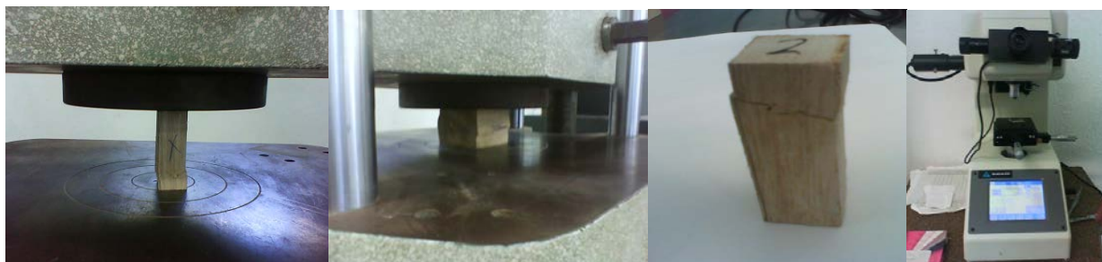
Figura 5. Imágenes de las probetas para compresión paralela y perpendicular a la fibra.
