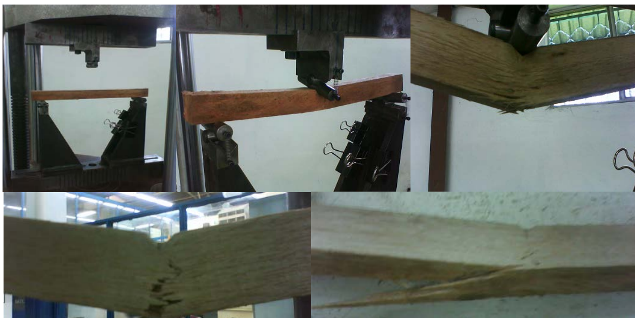
Figura 11. Imágenes de las probetas para tensión paralela y perpendicular a la fibra.
