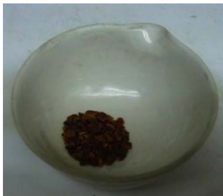
Figura 14. Mezcla 3% en peso de platino secada a temperatura ambiente antes de calcinarla.
