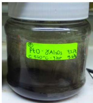
Figura 18. Recipiente que contiene los 6 catalizadores de 7% en peso de platino previo a la reducción.
