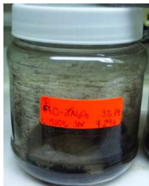
Figura 16. Recipiente que contiene los 6 catalizadores de 3% en peso de platino previo a la reducción.
