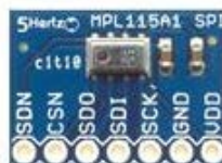
Fig. 1. 6 Sensor para medir presión barométrica MPL115A1
