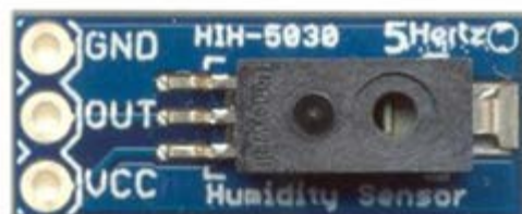
Fig. 1. 4 Sensor de humedad HIH-5030
