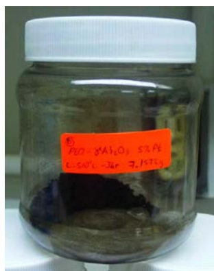
Figura 17. Recipiente que contiene los 6 catalizadores de 5% en peso de platino previo a la reducción.
