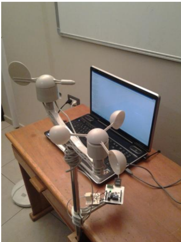
Fig. 1. 32 Conexión física de la estación meteorológica con una computadora para la lectura de datos a través del monitor serial
