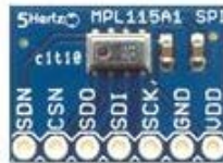
Fig. 1. 6 Sensor para medir presión barométrica MPL115A1
