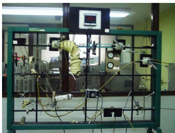
Figura 20. Equipo donde se realiza el proceso de reducción de los catalizadores.
