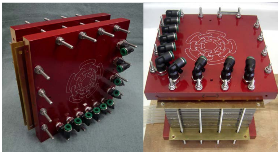
Figura 2. Celdas de combustible con un ensamble y el stack.
