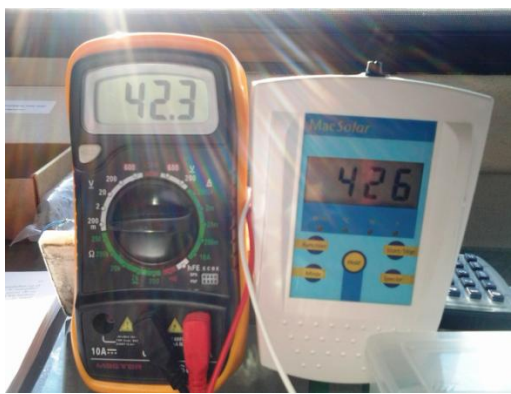
Fig. 1. 11 Comparación de la lectura del fotodiodo del valor de irradiación contra equipo MacSolar
