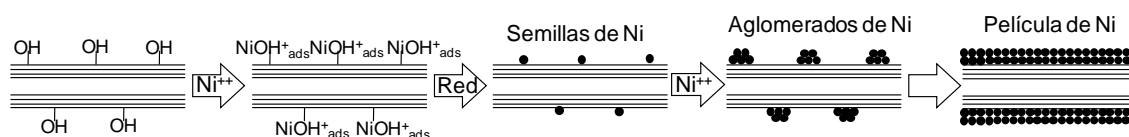
Figura 3. Etapas del depósito de Níquel por electroless en los NTC.
