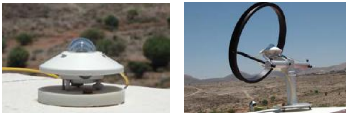
Figura 1. a). Piránometro para radiación Global, b). Piranómetro con aro de sombreado para radiación difusa.
