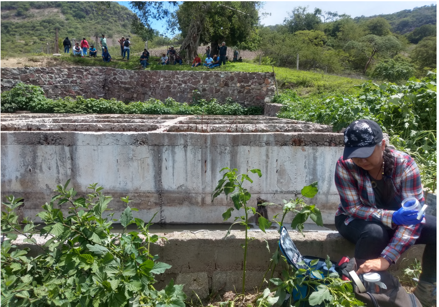
Figura 4. Muestreo de calidad de agua tratada con humedal comunitario en La Montaña, Guerrero. Fotografía de Mayrén Alavez Vargas.
