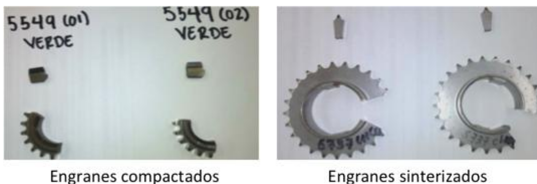
Fig. 1.- Piezas compactadas en verde y piezas sinterizadas.
