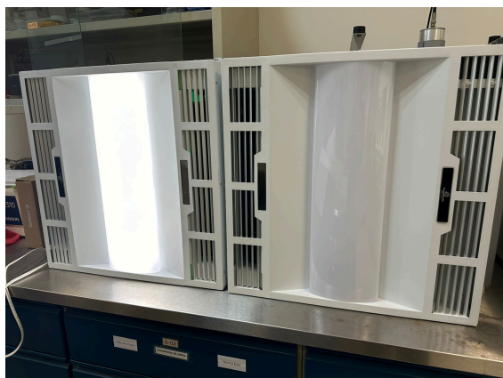
Figura 5.- Equipos para desinfección fotocatalítica que serán utilizados para las pruebas en entorno real, a realizar en un Hospital.
